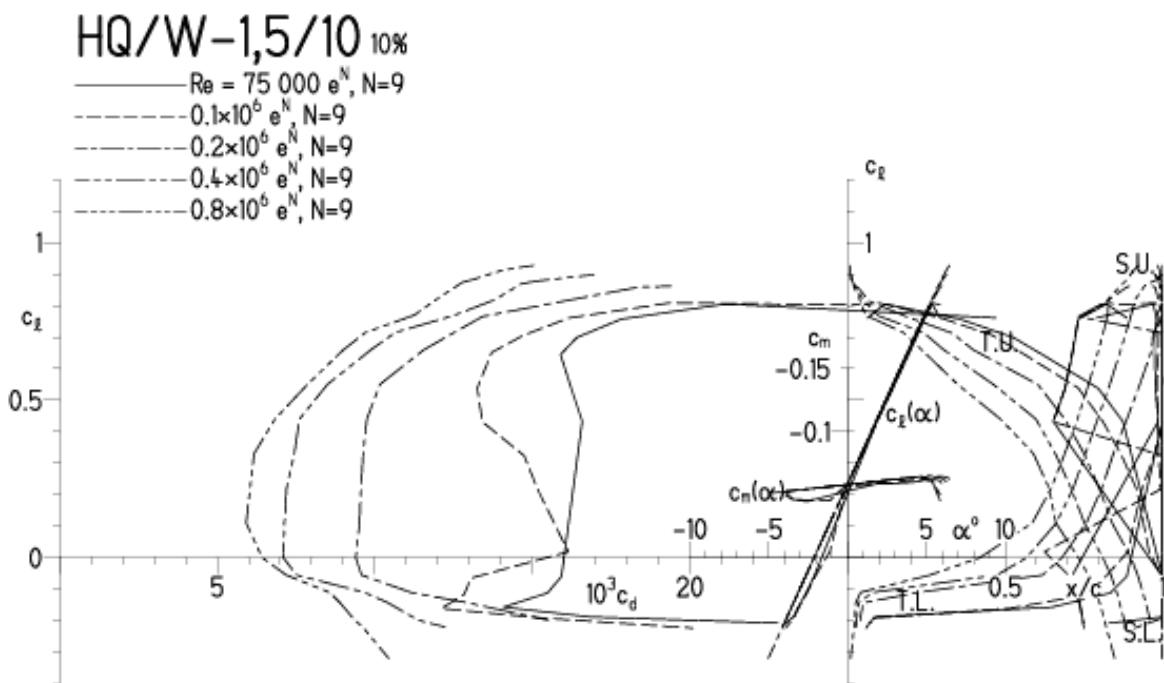
HQ/W-1,5/10, N=9, Turbulatoreffekt (optimal beim Maximum der Wölbung)
