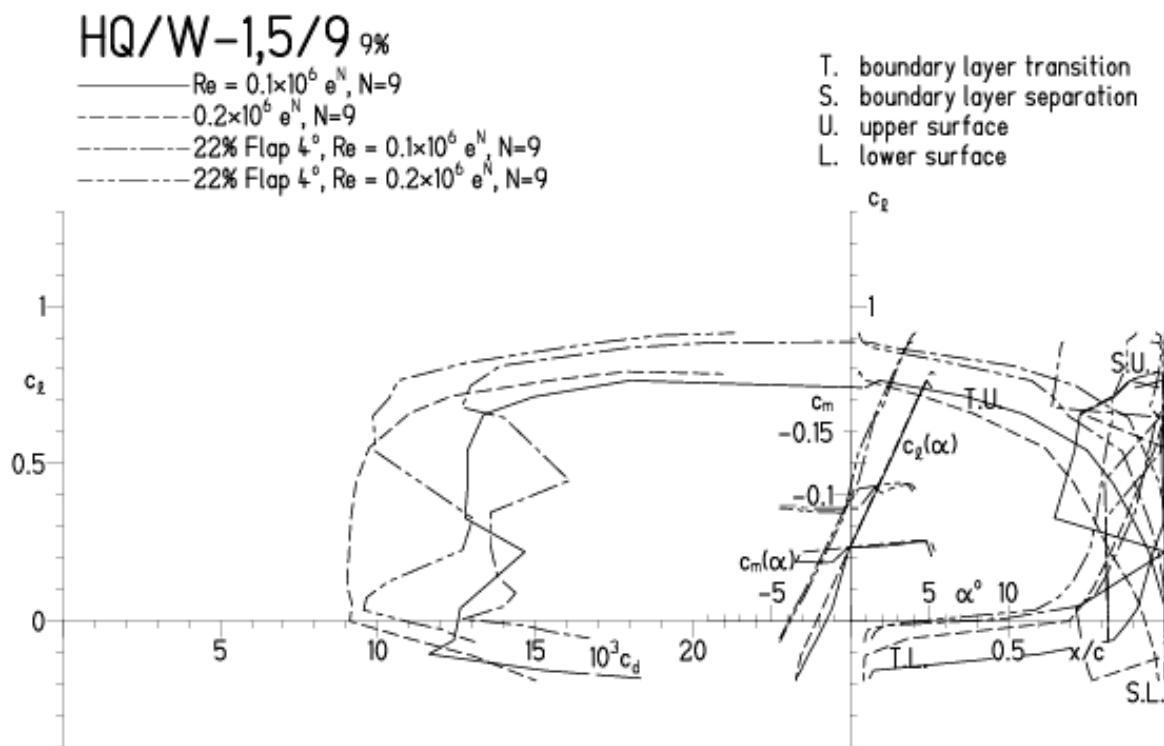
HQ/W-1,5/9, N=9, mit  $+4^\circ$  Wölbklappenausschlag, Turbulatoreffekt
