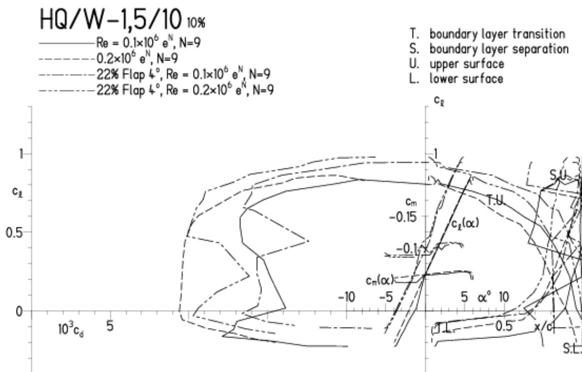
HQ/W-1,5/10, N=9, mit  $+4^\circ$  Wölbklappenausschlag, Turbulatoreffekt
