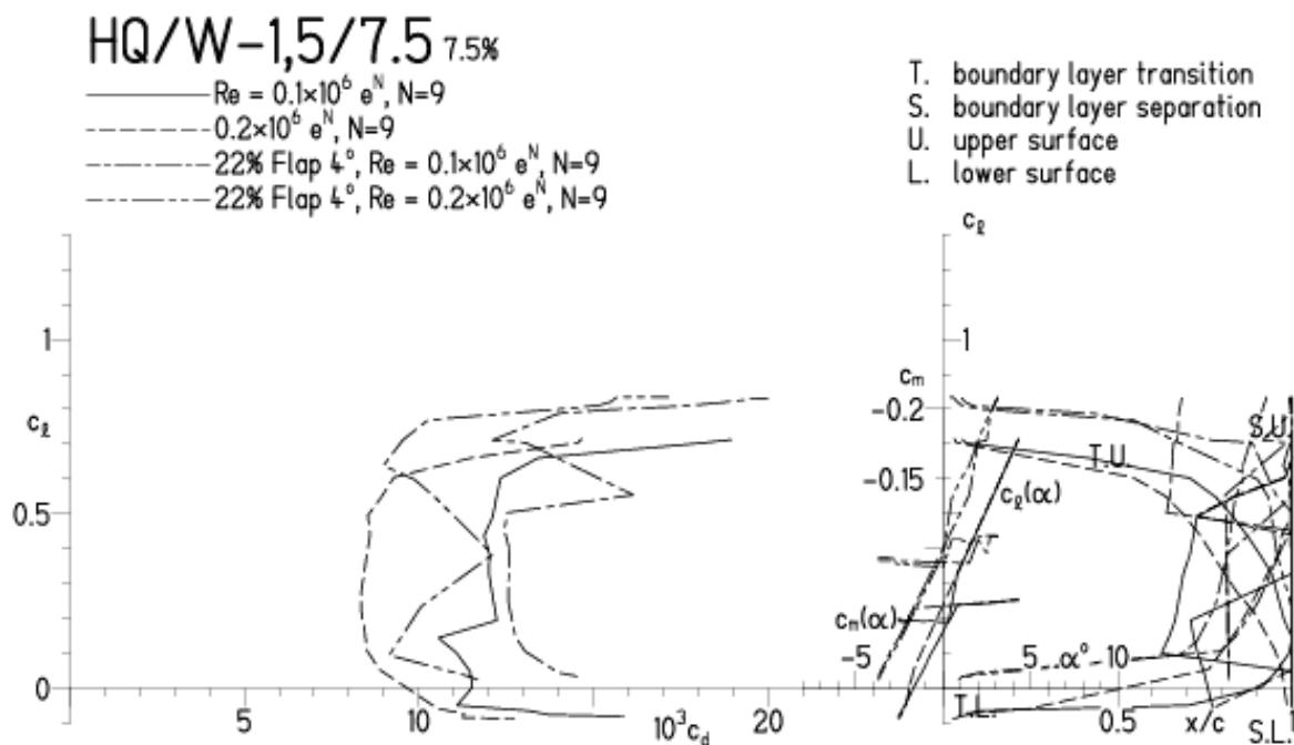
HQ/W-1.5/7.5, N=9, mit  $+4^\circ$  Wölbklappenausschlag, Turbulatoreffekt
