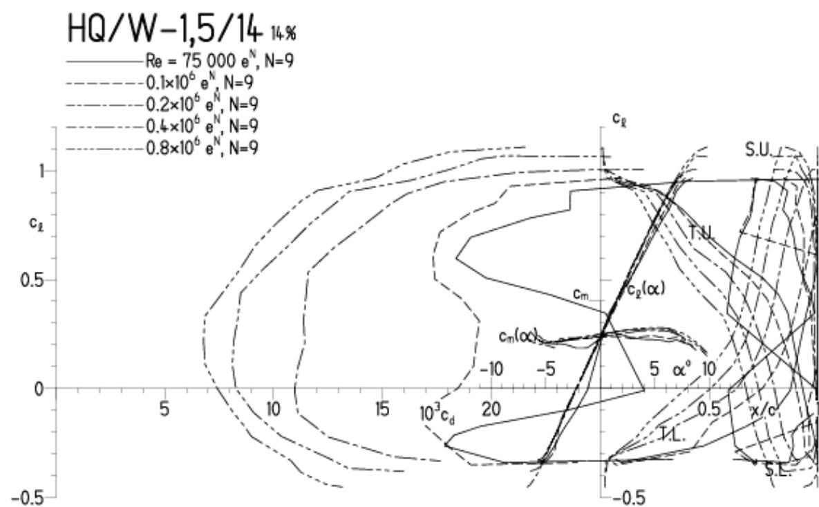
HQ/W-1,5/14, N=9, Turbulatoreffekt (optimal beim Maximum der Wölbung)
