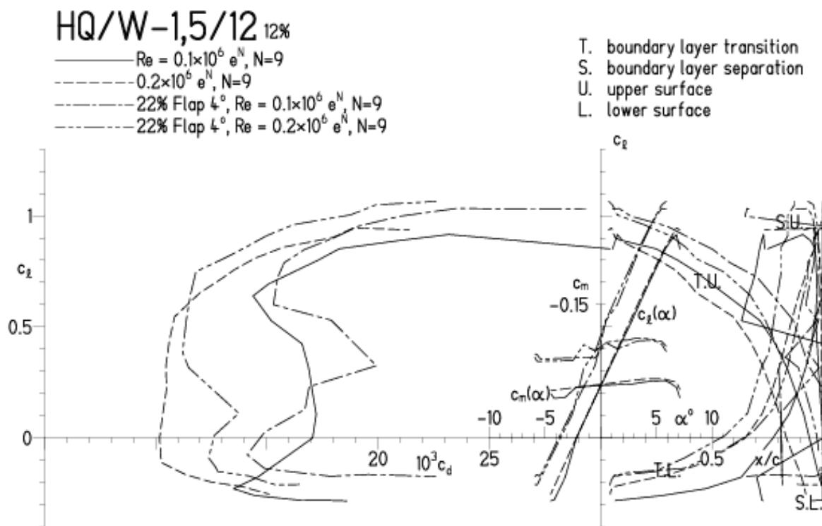
HQ/W-1,5/12, N=9, mit  $+4^\circ$  Wölbklappenausschlag, Turbulatoreffekt
