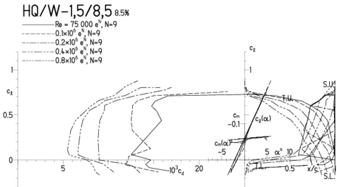
HQ/W-1,5/8,5, N=9, Turbulatoreffekt (optimal beim Maximum der Wölbung)
