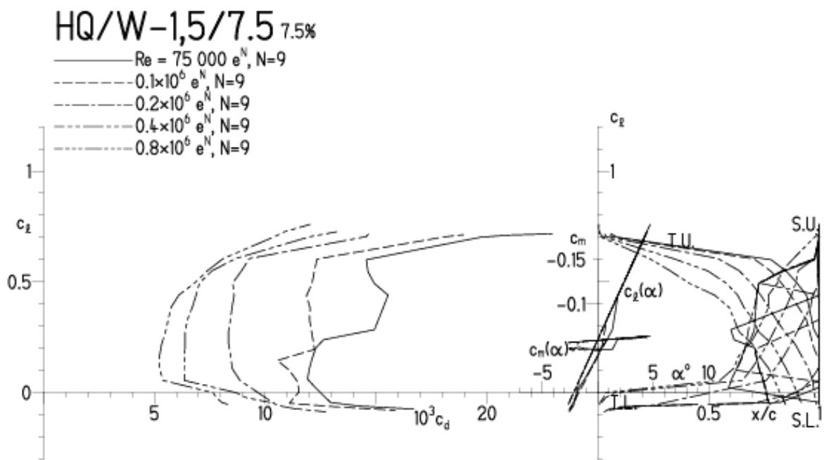
HQ/W-1,5/7,5, N=9, Turbulatoreffekt (optimal beim Maximum der Wölbung)
