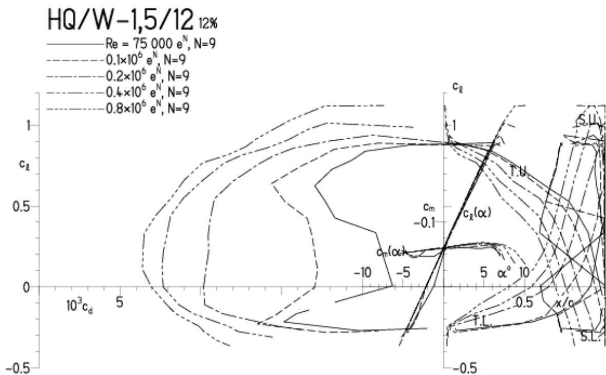
HQ/W-1.5/12, N=9, Turbulatoreffekt (optimal beim Maximum der Wölbung)
