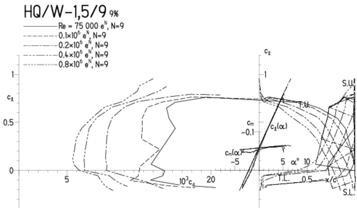
HQ/W-1.5/9, N=9, Turbulatoreffekt (optimal beim Maximum der Wölbung)
